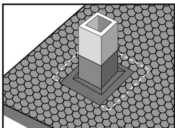
Полученные выкройкигибаются или надрезаются в определенных местах. Первоначально монтируется лицевая выкройка. Затем монтируется левая и правая выкройки. В последнюю очередь монтируется тыльная выкройка. При монтаже необходимо соблюдать принцип каскадности воды. Места сопряжения следует проклеить битумной мастикой Фиксер на величину 100 мм. Верхняя часть выкроек по периметру дополнительно крепится специальными прижимными планками.
