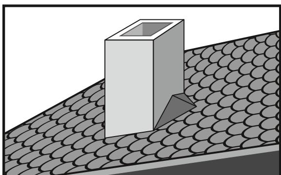
Для предотвращения скапливания снега за дымовыми и вентиляционными трубами, если их сечение превышает  $500 \times 500$  мм и они расположены поперек ската, рекомендуется устанавливать разжелобок.
