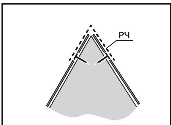
Аналогичным образом осуществляется монтаж второго ската кровли. Зона конька выполняется из Рулонной черепицы ТЕХНОНИКОЛЬ (РЧ) согласно схемы устройства коньковых и реберных элементов.
