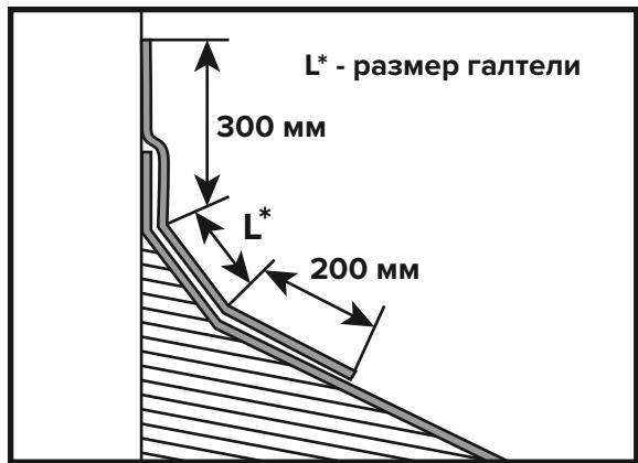
Для заведения на вертикальную поверхность используют Рулонную черепицу ТЕХНОНИКОЛЬ. Выкройки для заведения наверх следует укладывать внахлест не менее 200 мм на поверхность покрытия и с минимальным нахлестом 300 мм на заводимую поверхность дополнительно закрепив материал специализированными краевыми прижимными планками. Верхний стык планки герметизируется кровельным герметиком. Размер галтели уточняется по месту.
